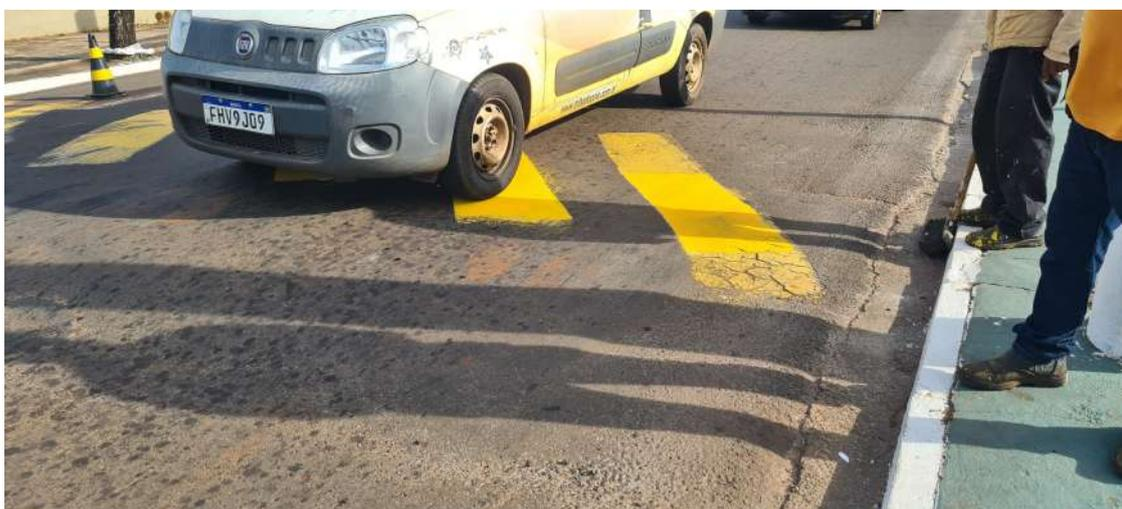
*Figura 17: Veículos passando sobre a área de testes.*
