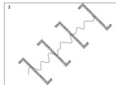
COLOCAR FERROS DE Ø 6,3 mm E PREENCHER COM ARGAMASSA CIMENTO / AREIA 1:3
