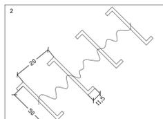
EXECUTAR RECORTES TIPO CANALETA NA ALVENARIA ESPACIADOS DE 20 cm, COM ESPESURA E PROFUNDIDADE DE 4 cm
