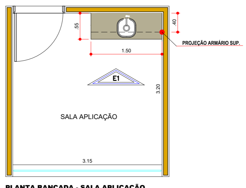
PLANTA BANCADA - SALA APLICAÇÃO ESC 1:50
